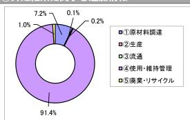
使用・維持管理段階のGHG排出量は、JISC4304:2013(配電用6kV油入変圧器)9.試験 /9.9エネルギー消費効率による算出式により算出した年間電力使用量をベースに想定使用 期間を掛け、これに日本平均の電力の排出係数を用いて算出した。
