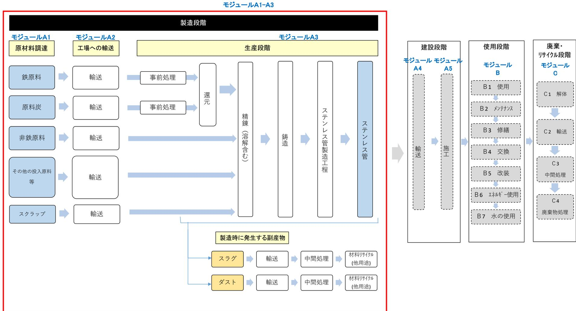
※全てのエネルギーおよび水の供給と使用に係るプロセスはフロー図から省略
