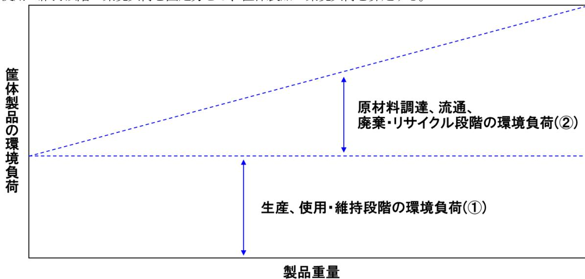
$$\text{筐体製品の環境負荷} = \text{製品重量} \times \text{②} + \text{①}$$
