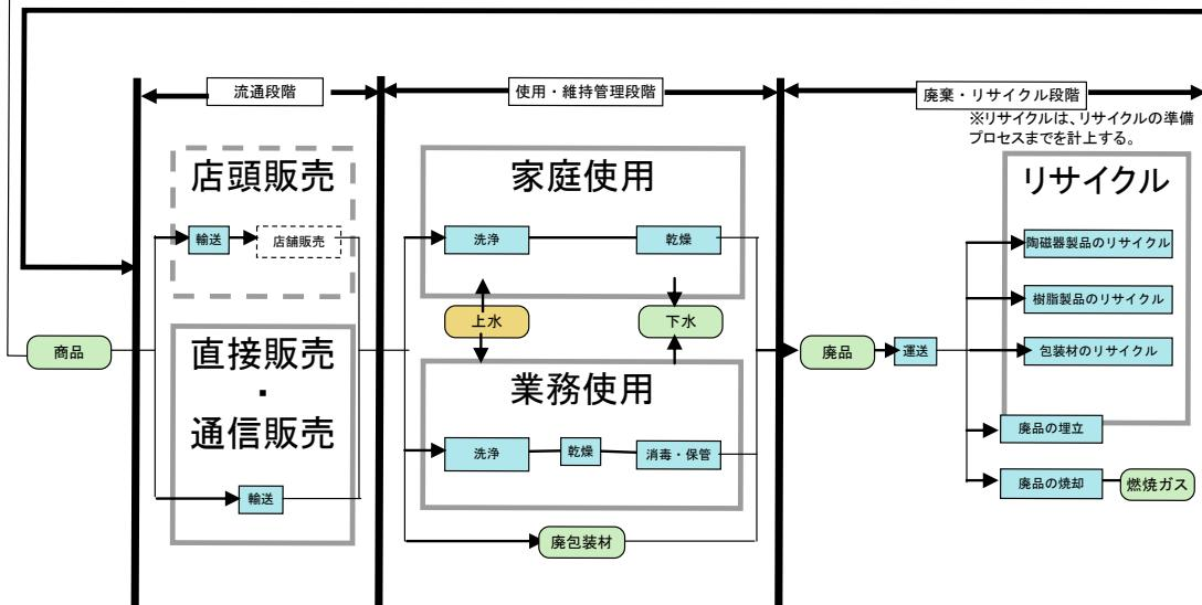
「燃料」や「電力」・「工業用水」の供給に関わるプロセスは、全ライフサイクル段階で共通のため、フロー図からは省略
